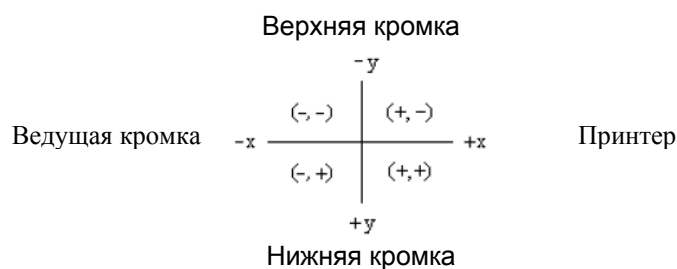
Рис. 10-5. Оси калибровки режущего механизма
